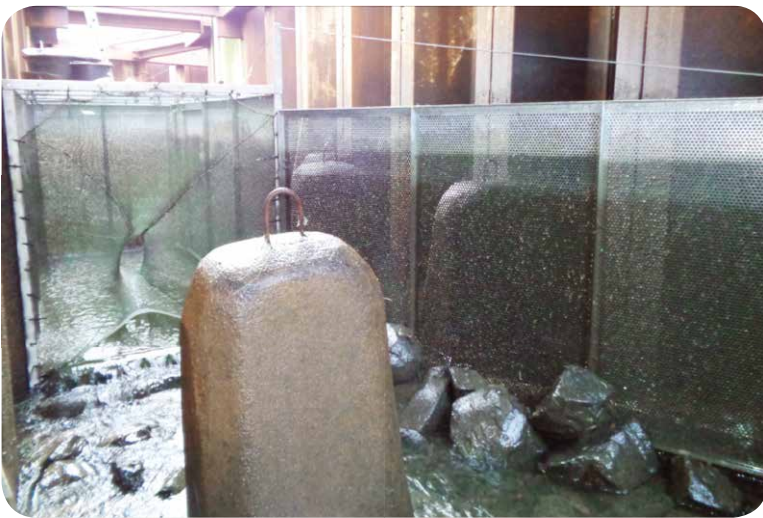
Bild 1: Fangeinrichtung mit Rechen und 10 mm Netzreuse; Ansicht stromauf
