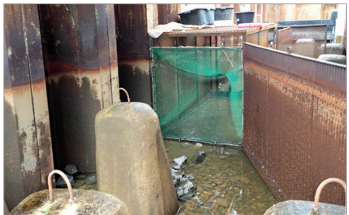
Bild 1: Fangeinrichtung mit 10 mm Netzreuse
