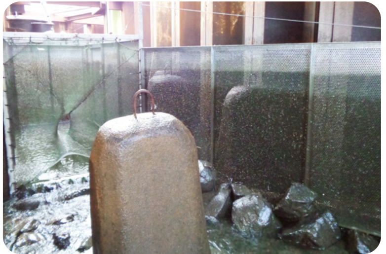
Abb. 2: Fangeinrichtung mit unterem Rechen und 10 mm Netzreue.
